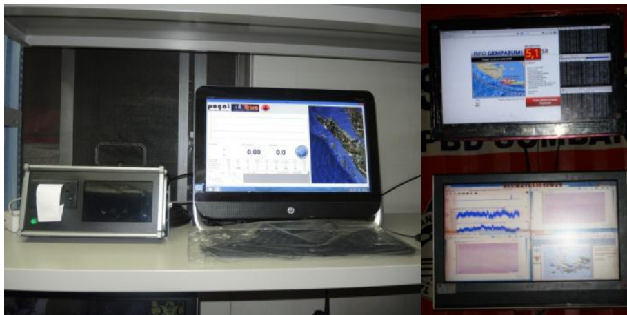
Gambar 14. (a) Seismogram dengan Intensiti meter (b) pemantauan aktifitas seismik pada stasiun-stasiun online
