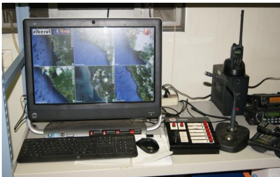
Gambar 16. Foto Sistem Pemberitahuan Gempa berpotensi Tsunami, dilengkapi dengan Sirine peringatan berjenjang dan Suara
