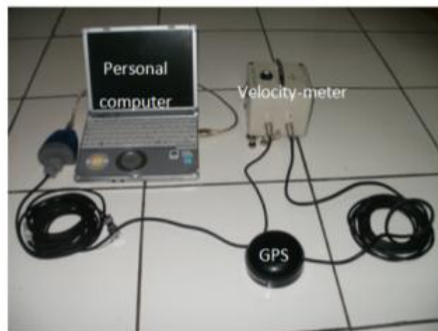
Gambar 4. Peralatan pengukuran mikrotremor yang digunakan: velocity-meter Geodaqs (Butan Service Co.) dan GPS yang tersambung dengan personal computer/ laptop .
