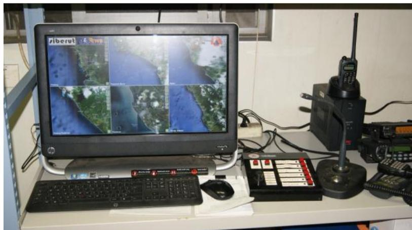
Gambar 3.16. Foto Sistem Pemberitahuan Gempa berpotensi Tsunami, dilengkapi dengan Sirine peringatan berjenjang dan Suara.
