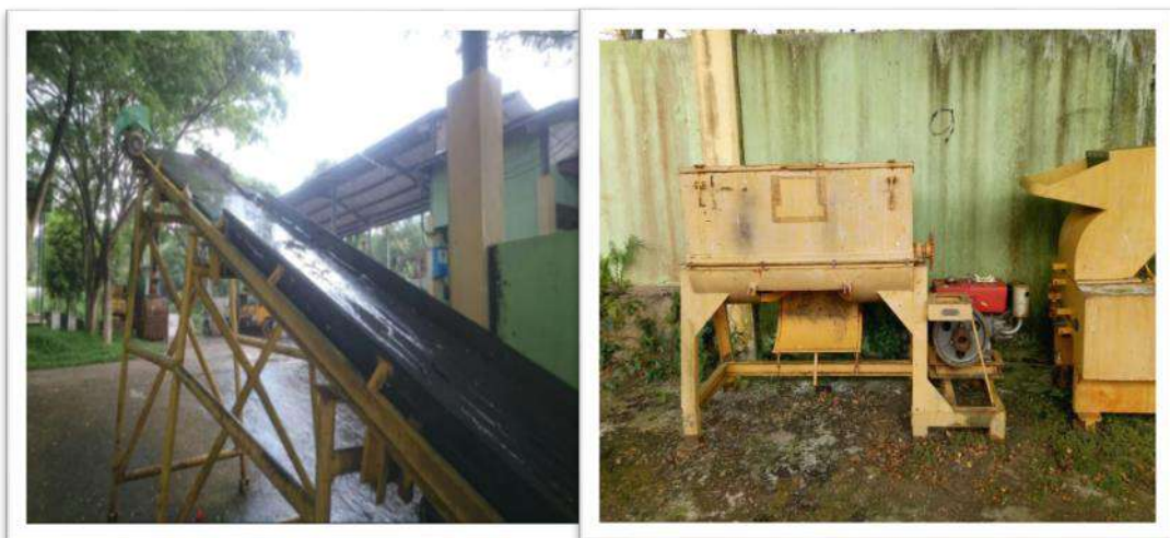
Gambar 2.14 Belt Conveyor dan Mesin Pencacah di TPA Sampah Regional Payakumbuh
