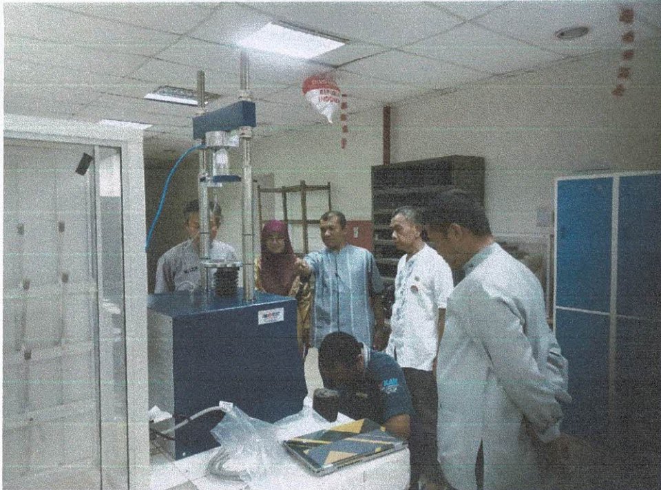
Gambar 1: Instalasi dan Pemeriksaan Kelengkapan Alat Marshall Stability
